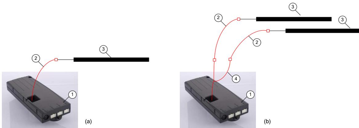
Abbildung 6: Anschluss einer einzelnen Quetschschutzleiste (a) und von zwei Quetschschutzleisten (b)
